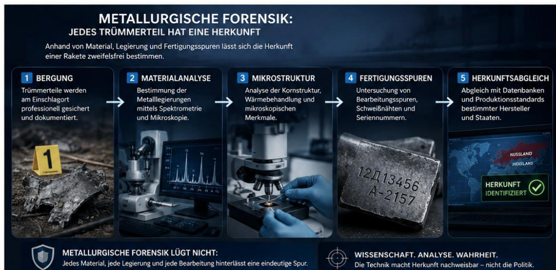
Abb. 5 | Metallurgische Forensik im Ermittlungsprozess: Von der Bergung eines Trümmerteils bis zum eindeutigen Herkunftsnachweis durch Material- und Herstellungsanalyse. Grafik: Eigene Darstellung.
